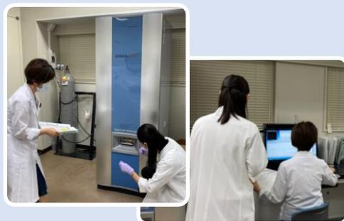
ADRESに設置されているMALDI-TOF MS (AXIMA-TOF<sup>2</sup>/島津製作所) を使用して、ペプチドスタンダードを用いた装置のキャリブレーション手順と、BSAの消化物やタンパク質の測定方法をレクチャーしました。
