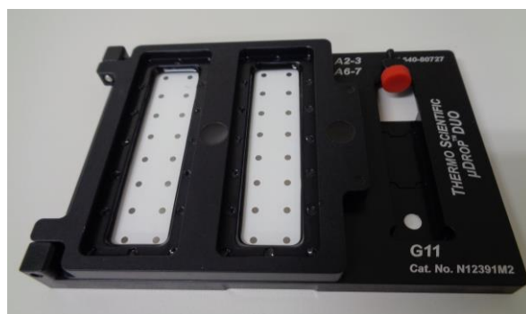
付属の \mu Drop™ Duo plate 2~10 \mu l の少量サンプルを 同時に32個まで測定が可能です。
