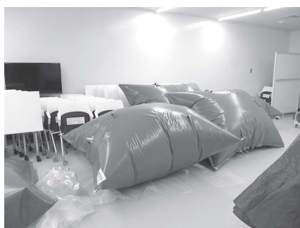
使用済NMRから回収したヘリウムガス
