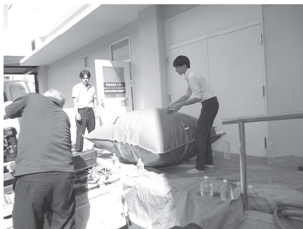
ヘリウムガスバッグから移動式圧縮機に供給する
