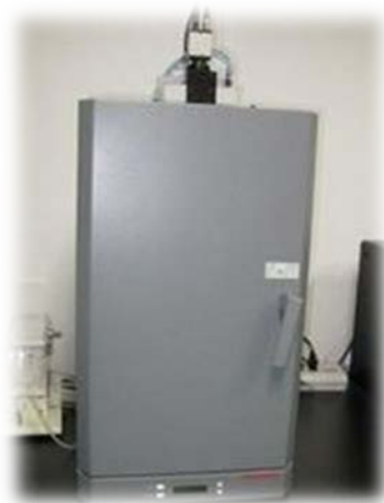
(写真 2) 発光マクロイメージングシステム (AEQUORIA-2D/8600)
