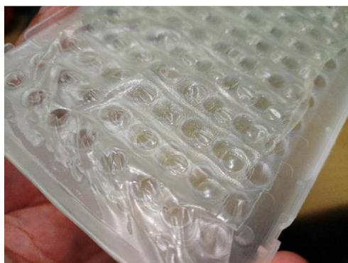
←不適切なシールを使用していた為熱で溶けて、装置に張り付いてしまった。
